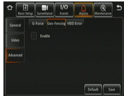
Alarme de géo-blocage – Figure 97
