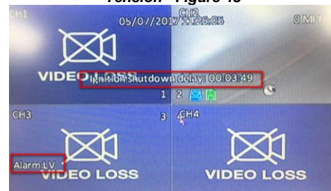
Arrêt différé à basse tension – Figure 44
